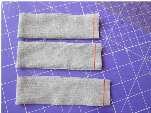
Die Bündchenstreifen werden rechts auf rechts zur Mitte gefaltet und an den kurzen, offenen Seiten entsprechend der roten Linien unter Einhaltung der Nahtzugabe zum Ring genäht. Dazu kannst du die Overlock oder einen elastischen Stich wählen, ich bevorzuge den dreifachen Geradstich, damit ich die NZ anschließend knapp zurückschneiden kann.
