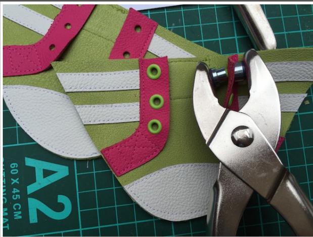
Nach Geschmack können die gestanzten Löcher noch zusätzlich mit Ösen verziert werden. Ich nutze dabei eine 4mm Lochzange und 4mm Ösen mit dem Osenwerkzeug der Prym Vario Zange. Die farbigen Ösen sind aus dem Scrapbookingbedarf.
