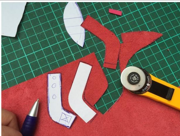
Schneide die Einzelteile zunächst aus Papier und anschließend doppelt, gegengleich aus Leder zu (einmal mit der bemalten Seite nach oben, einmal mit Selbiger nach unten ausschneiden).
