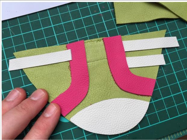
Jetzt werden Zehenkappe (1) und Seitenstreifen (3) aufgeklebt und festgenäht (blaue Nähte im Schema). Die Blenden werden zur Orientierung ebenfalls bereits jetzt aufgeklebt, aber erst anschließend angenäht. Hier siehst du gut, wie die Seitenstreifen von den Rändern der Blenden überragt werden.
